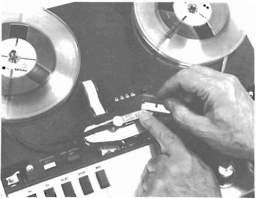
*Impiego dell'utensile Unitronic per una giunta sul nastro, e lama Unitronic taglianastro.*
